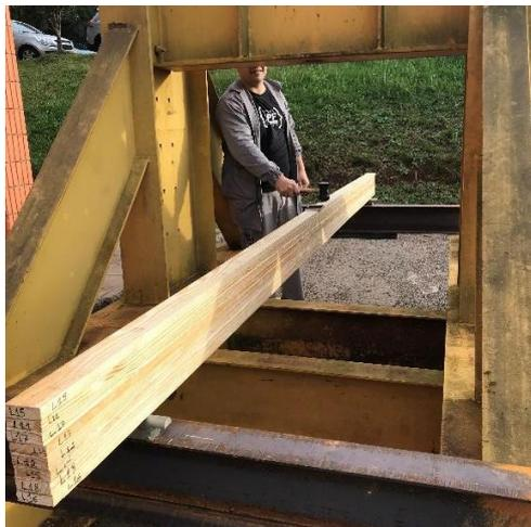
Figura 2. Frequência fundamental das vigas, medida com Smartphone.
