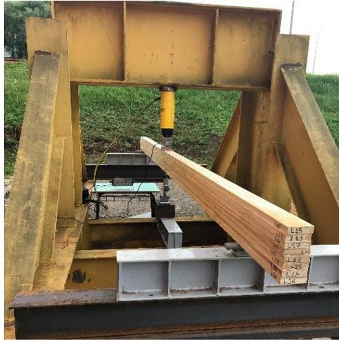
Figura 1. Ensaio de rigidez á flexão das vigas de MLC.
