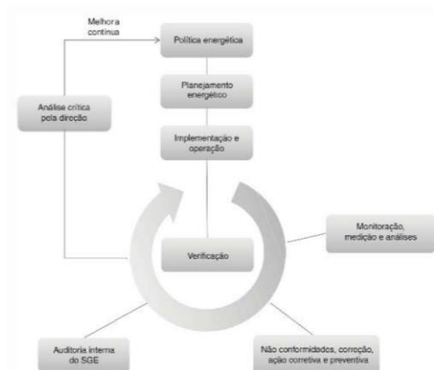
Figura 1 – Modelo de Sistema de Gestão da Energia para a Norma ISO 50001.
