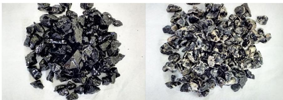
Figura 1 – Comparação entre as amostras de mistura asfáltica antes (a) e depois (b) do processo de lixiviação.
