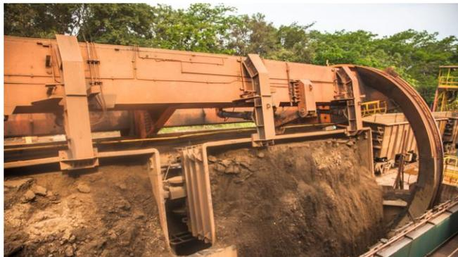
Figura 1 – Virador de vagões de minério de ferro
